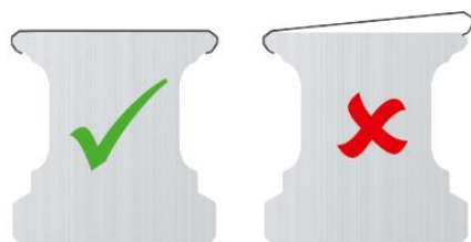
Rys. 5.45: Prawidłowo i nieprawidłowo zamontowana taśma osłonowa
