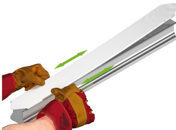
Rys. 5.27: Montowanie taśmy osłonowej
